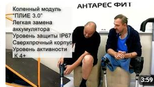
Микропроцессорный коленный модуль «ПЛИЕ 3.0» — уровень активности К 4+ 118 просмотров · 9 дней назад
